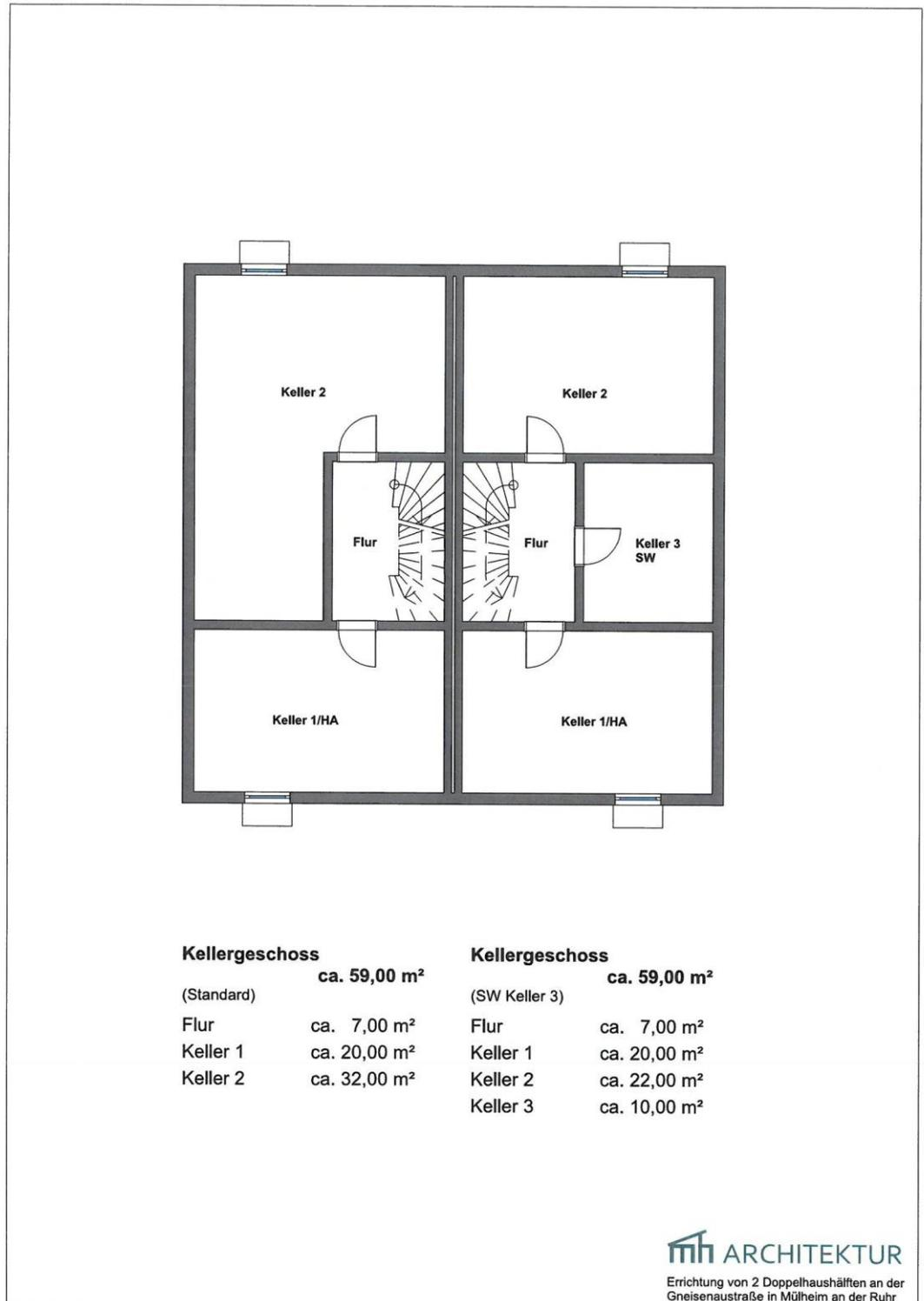
*Grundriss Keller mit Variante „Vollunterkellerung aus WU-Beton mit Außendämmung.“*
